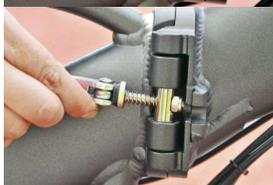
Za odklep objemke privzdignite ročico, kot prikazuje slika 12.
