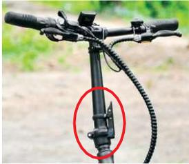
Najprej odpnite varnostni zatič, prikazan na sliki 5, nato odprite objemko, prikazano na slikah 4 in 5.
