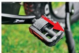
Povlecite pedalo v prikazani smeri (slika 2), dokler ga ne zložite (slika 3).
